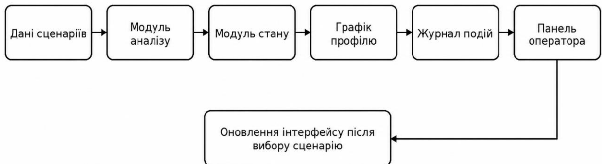
Рисунок 3.6 – Структура програмних компонентів вебінтерфейсу
