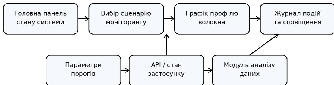
Рисунок 2.3 – Структура вебінтерфейсу оператора системи моніторингу
