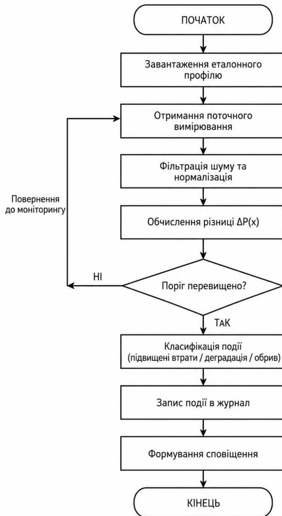
Рисунок 1.5 – Блок-схема алгоритму виявлення аномалій
