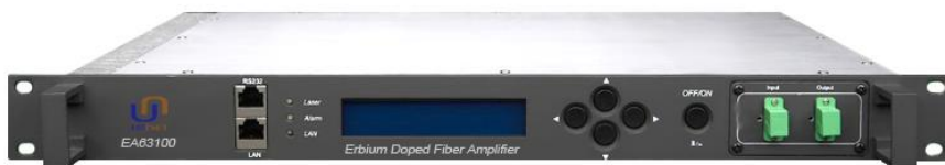
Рисунок 2.3 - Варіант пристрою EA 63200 для підсилення оптичного сигналу для одного волокна
