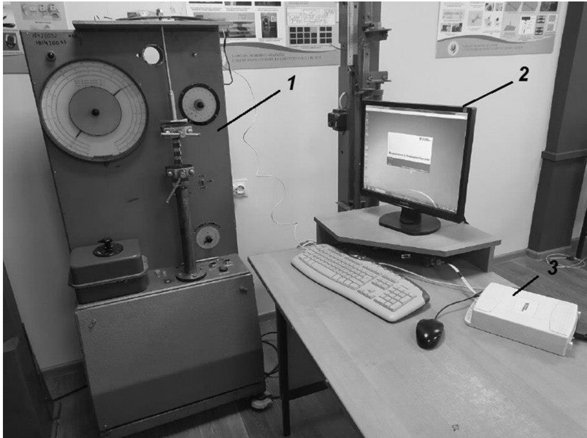
1-розривна машина; 2-компютер; 3-вимірювальне устаткування Рисунок 3.3 – Фото стенду для дослідження розриву матеріалів:
