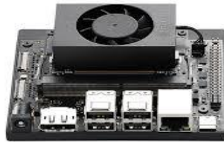
Рисунок 2.1 – NVIDIA Jetson Orin Nano
