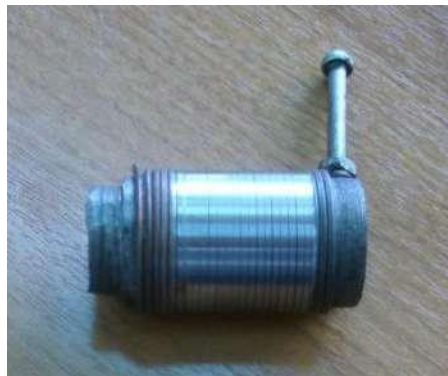
Рисунок 3.4 - Результати круглого шліфування пружинного вкладиша на оправленні.
