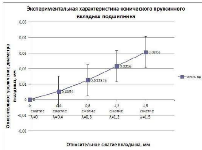
Рисунок 4.19 - Характеристика конічного пружинного вкладиша підшипника сайлентблока
