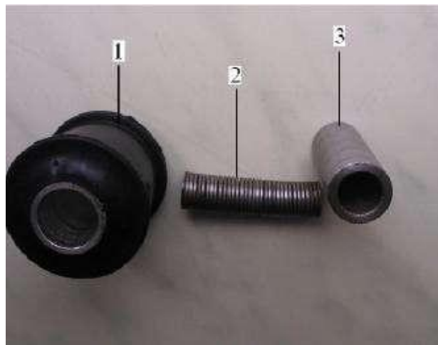
Рисунок 4.18 - Ремонтний комплект деталей для інноваційного сайленблока
