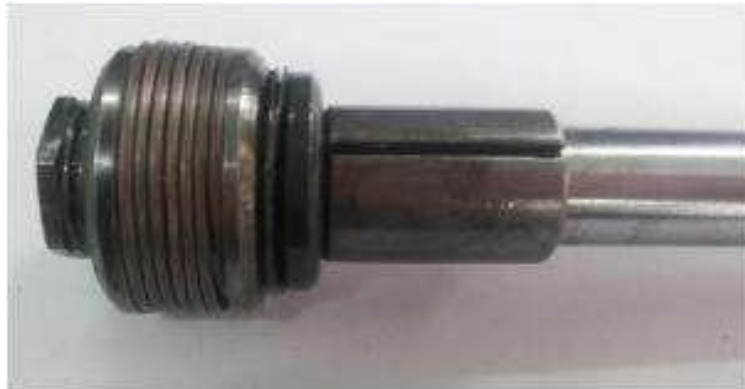
Рисунок 3.5 - Поршень, який складається з ущільнювальним обмідненим пружинним вкладишем
