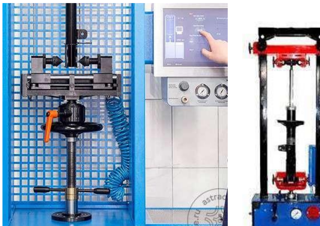
Рисунок 3.6 - Експериментальна установка для дослідження амортизаторів по зусиллю стискання та вітбою
