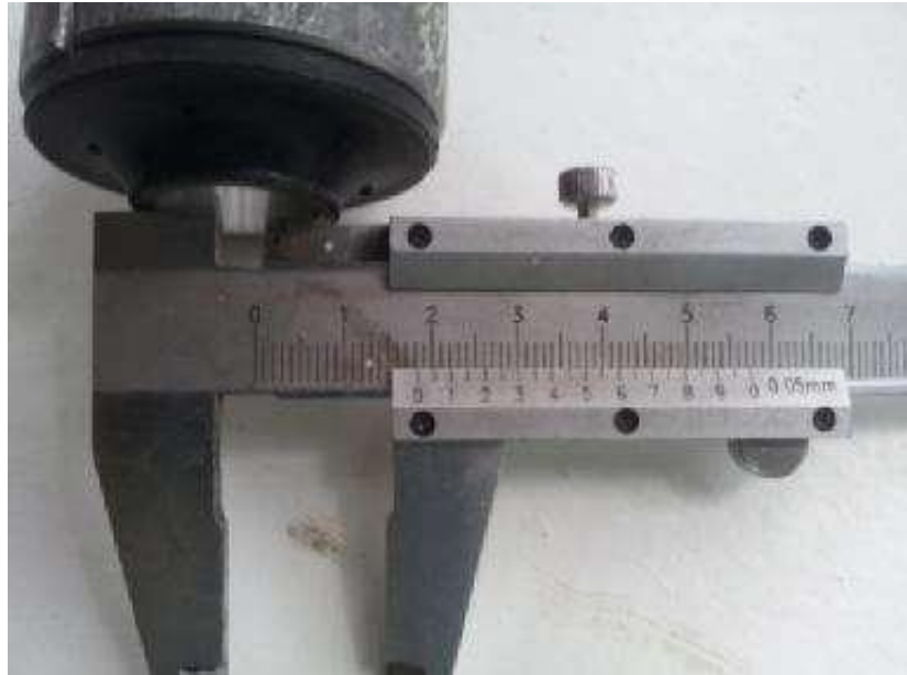
Рисунок 4.16 - Розточений внутрішній діаметр алюмінієвої втулки сайлентблока
