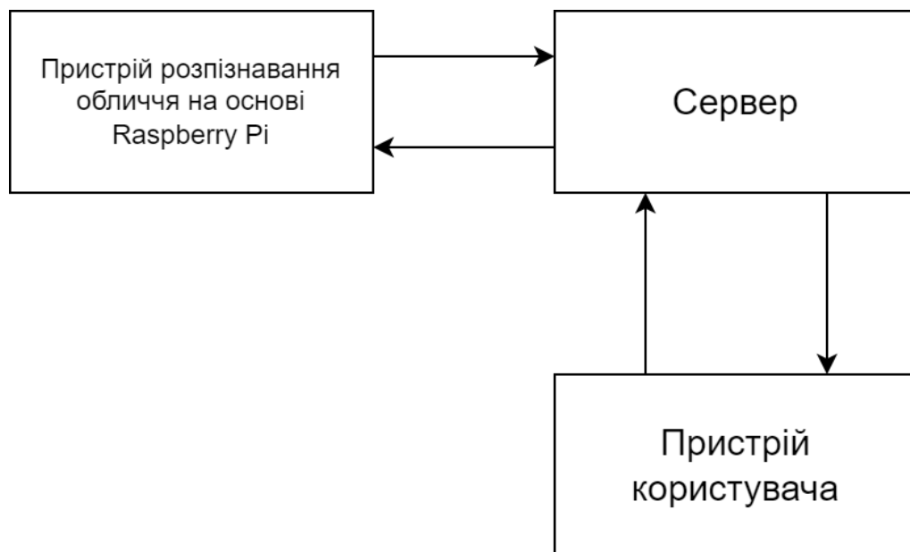
Рисунок 3.9 – Узагальнена архітектура програмно-технічного засобу для розпізнавання емоцій обличчя на основі Raspberry PI
