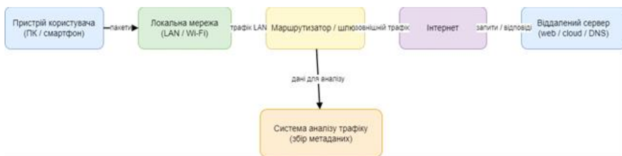
Рисунок 1.1 – Узагальнена схема передавання інтернет-трафіку в комп'ютерній мережі
