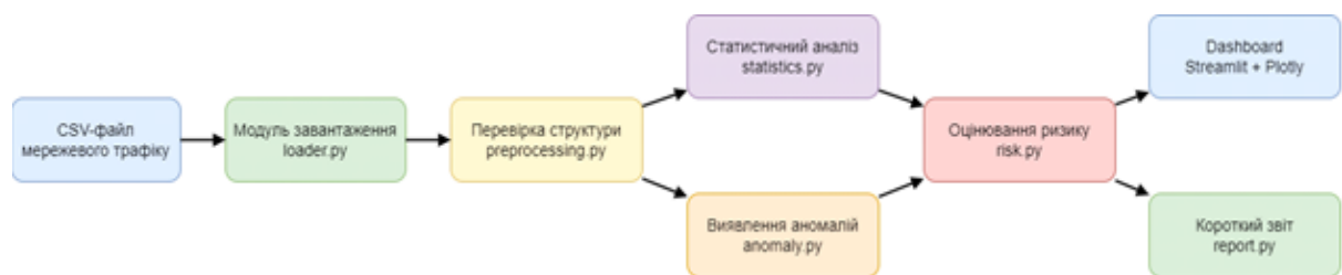
Рисунок 3.1 – Архітектура програмної системи аналізу інтернет-трафіку
