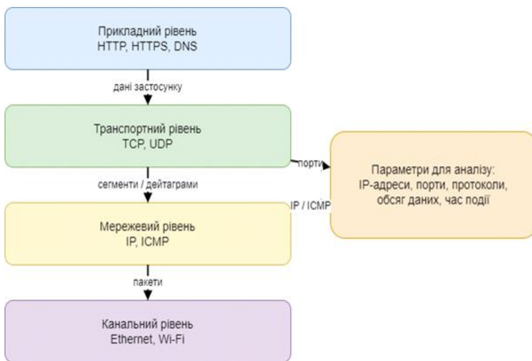
Рисунок 1.2 – Рівні мережевої взаємодії та приклади протоколів
