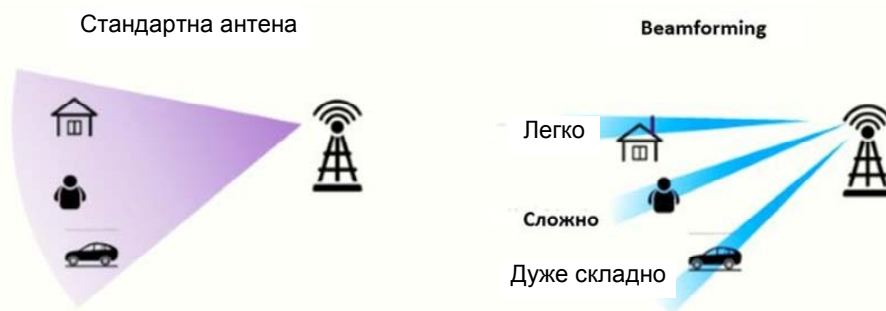
Рисунок 1.4 – Формування променів Beamforming.
