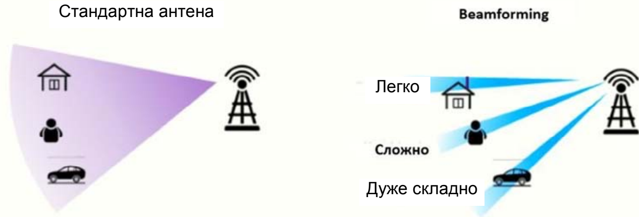
Рисунок 2 – Формування променів Beamforming.
