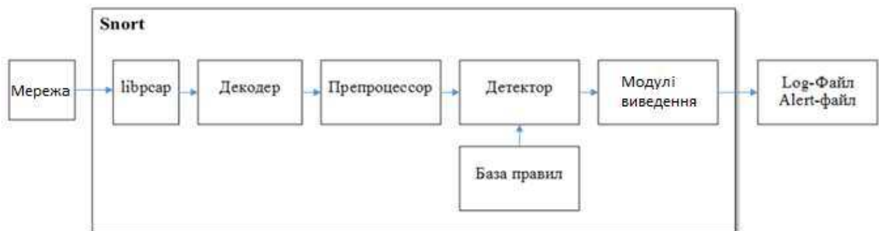
Рисунок 3.6 – Принцип роботи Snort
