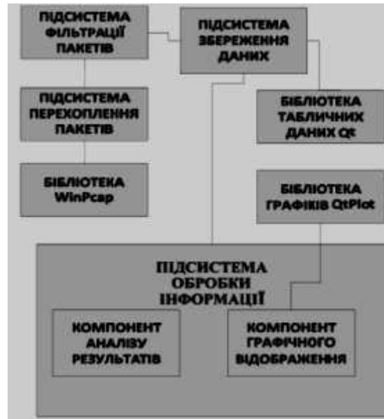
Рисунок 2.3 – Структура системи автоматизації обліку та аналізу трафіку мережевих комунікацій
