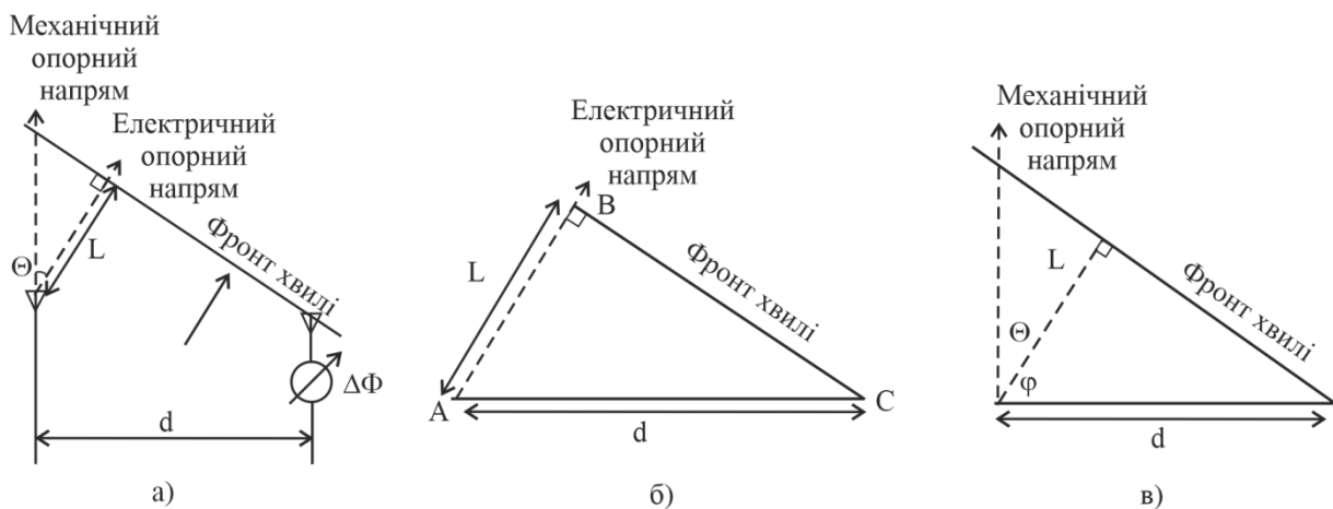
Рисунок 3.3 - Отримання фазового зсуву \Delta\Phi між сусідніми елементами решітки
