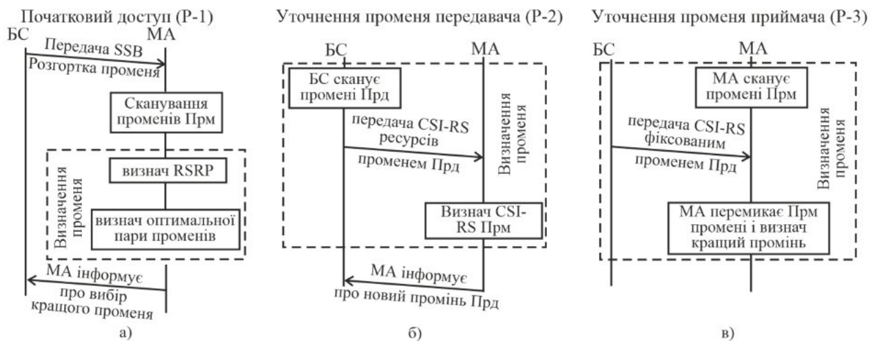
Рис. 4. Схематичне зображення процедур управління променем: а – процедура P-1; б – Процедура P-2; в – процедура P-3 (БС – базова станція; МА – мобільний абонент; Прд – передавач; Прм - приймач)
