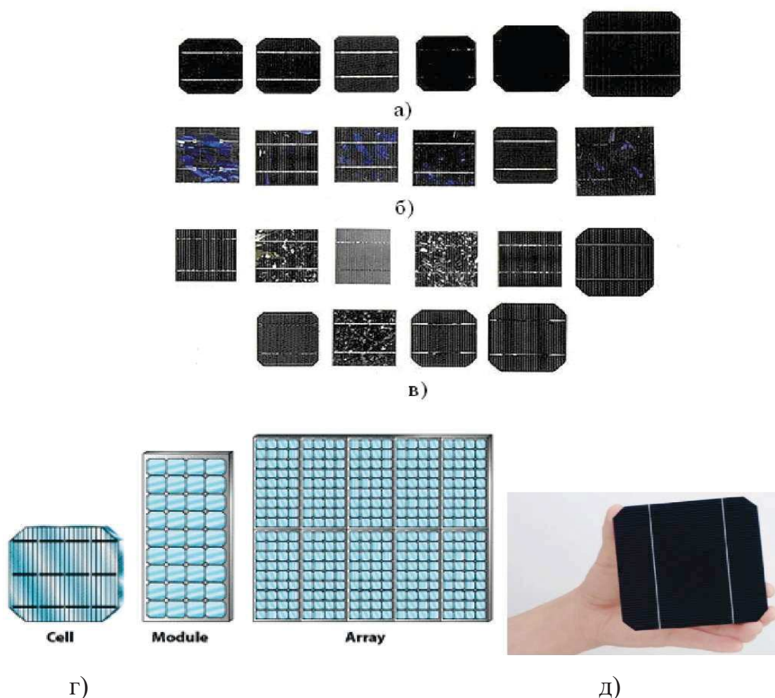
Рисунок 1.6 - Вигляд різних типів сонячних елементів: а) монокристалічних ; б)полікристалічних ; в) тонкоплівкових; г) конструкція сонячних панелей на базі ФЕП; д) одиночна пластина кристалічного ФЕП
