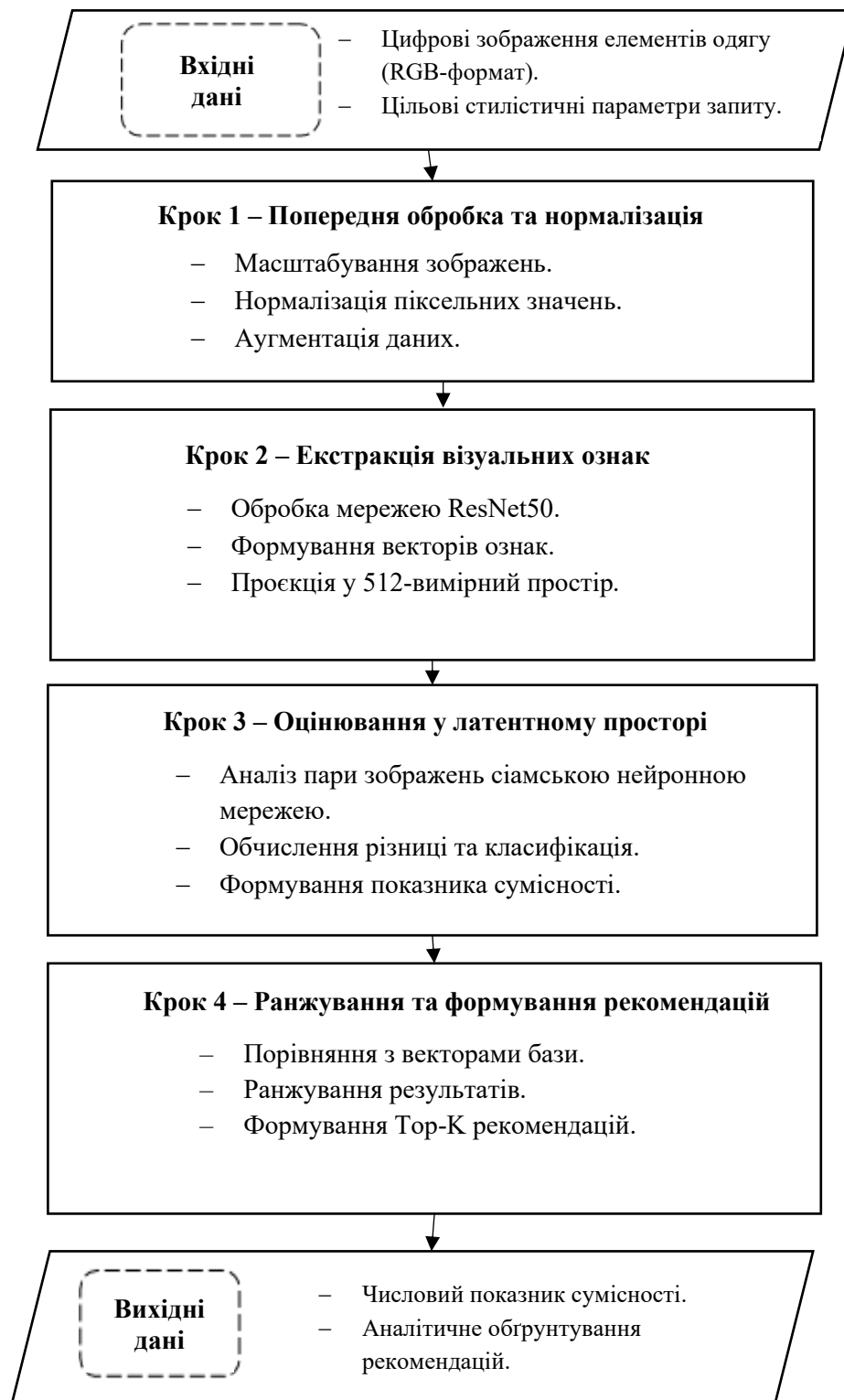
Рисунок 2.1 – Структурна схема методу оцінювання візуальної сумісності елементів одягу
