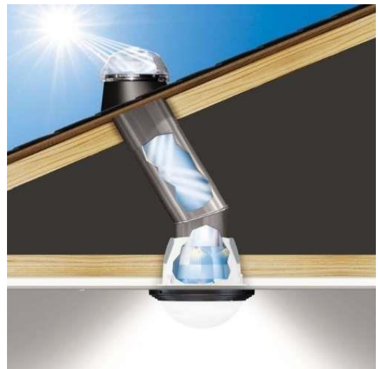
Рисунок 1.2 - Приклад світлового колодязя
