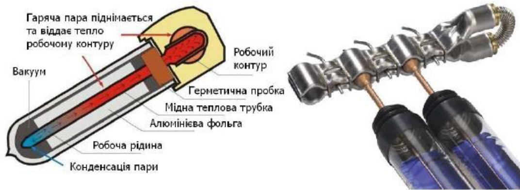
Рисунок 1.16 – Принцип роботи сонячного вакуумного колектора
