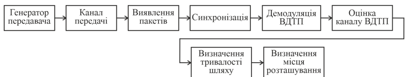
Рисунок 3.1 – Структурна схема обробки каналу мобільна станція – точка доступу (ВДТП – високоефективне довге тренувальне поле)
