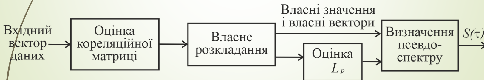
Рисунок 5.2 – Структурна схема оцінки часу прибуття за алгоритмом MUSIC
