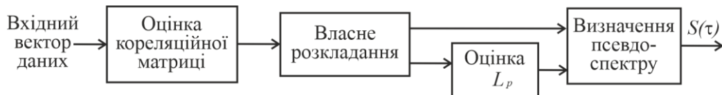
Рисунок 2.2 – Структурна схема алгоритма оцінки часу прибуття з надвисокою роздільною здатністю MUSIC
