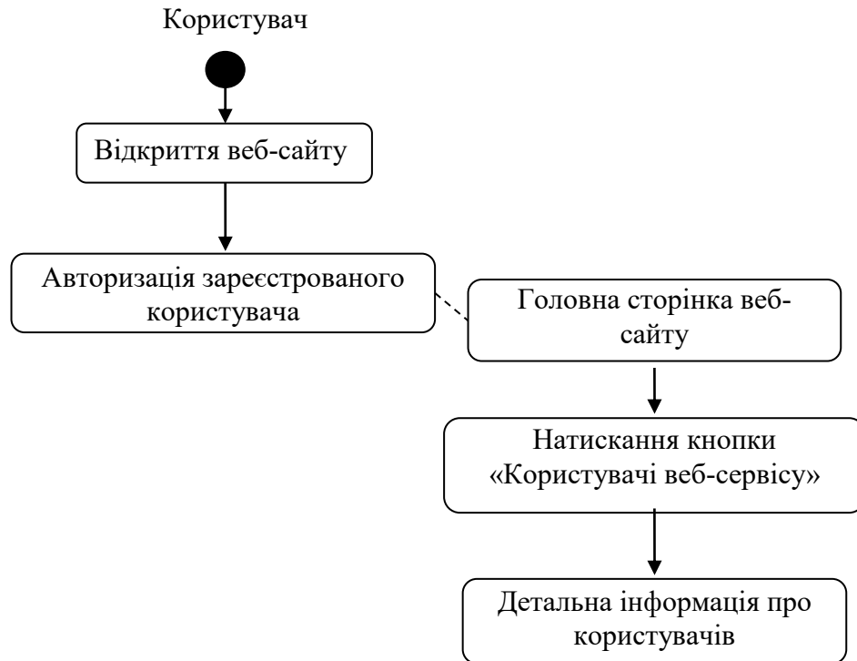
Рисунок 2.5 – Діаграма дій бізнес-процесу «Робота з користувачами веб-сервісу».
