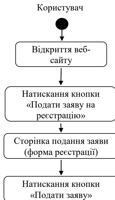
Рисунок 2.2 – Діаграма дій бізнес-процесу «Робота з поданням заявки на реєстрацію в системі».
