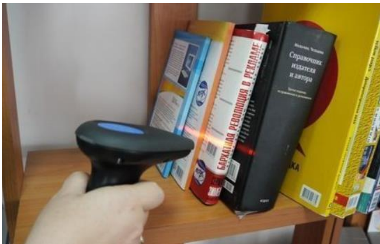
Рисунок 1.3 – Процес зчитування штрих-коду
