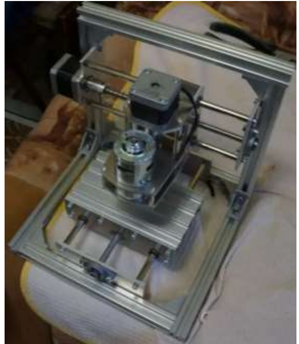
Рисунок 2.9 – Зборка механізму шпинделя
