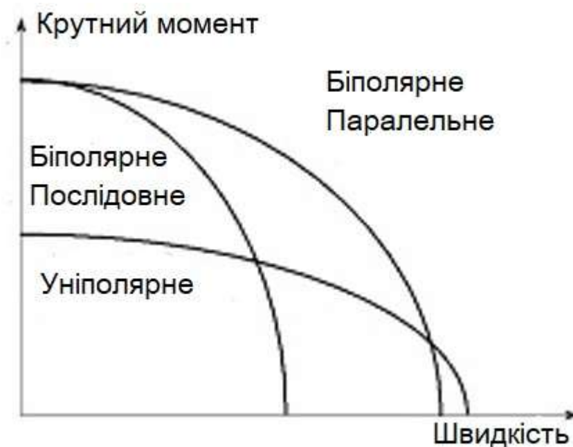
Рисунок 2.13 - Графік залежності швидкості від крутного моменту крокового двигуна
