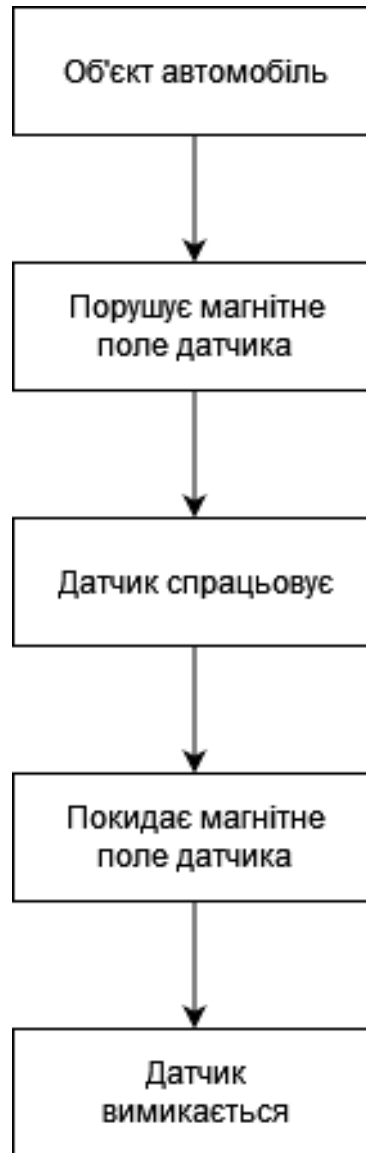
Рисунок 1.7 – Алгоритм роботи магнітного датчика
