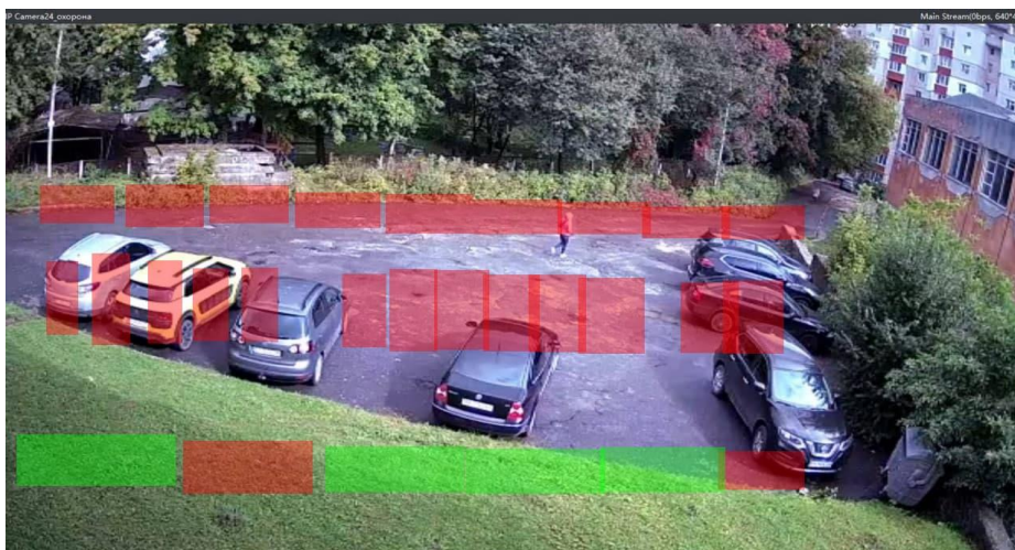
Рисунок 3.4 - Приклад роботи підсистеми для розпізнавання зображення з камери зовнішнього спостереження паркомайданчика Хмельницького національного університету
