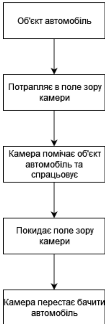
Рисунок 1.9 – Алгоритм роботи методу на основі камери зовнішнього спостереження
