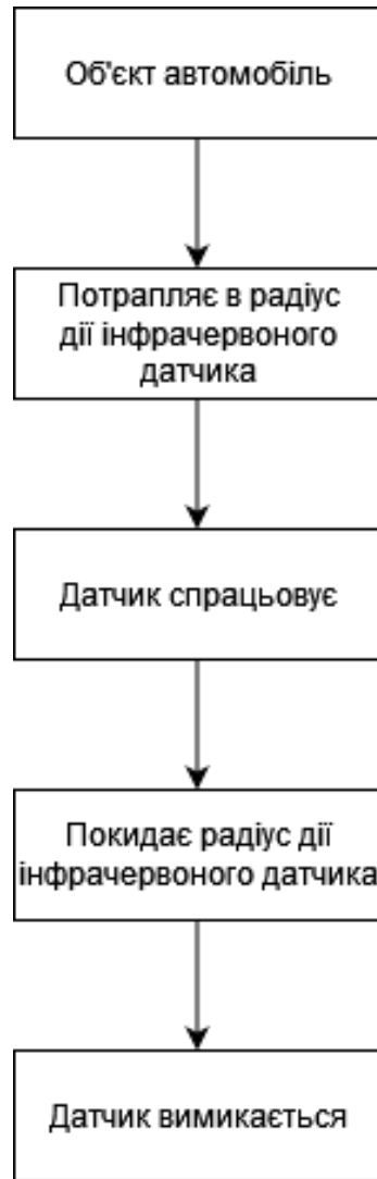
Рисунок 1.8 – Алгоритм роботи інфрачервоного датчика
