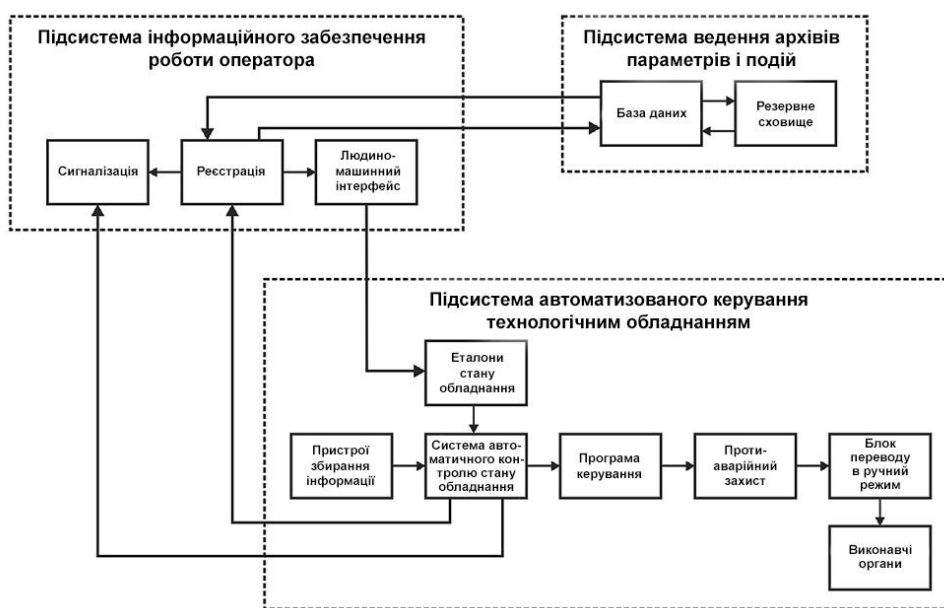
Рисунок 2.1 – Структура програмно-апаратного засобу контролю умов зберігання медикаментів і вакцин
