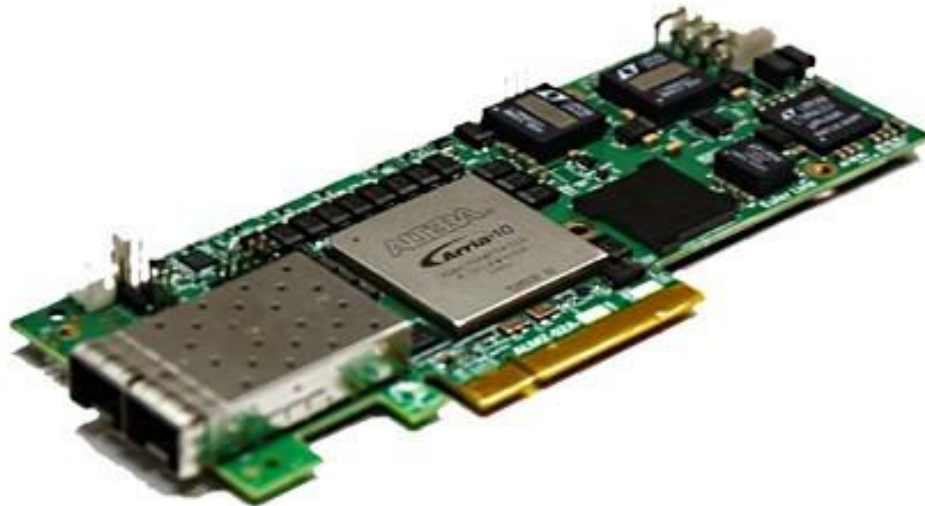
Рисунок 1.1 – приклад FPGA прискорювача з чіпом Intel Altera [52]
