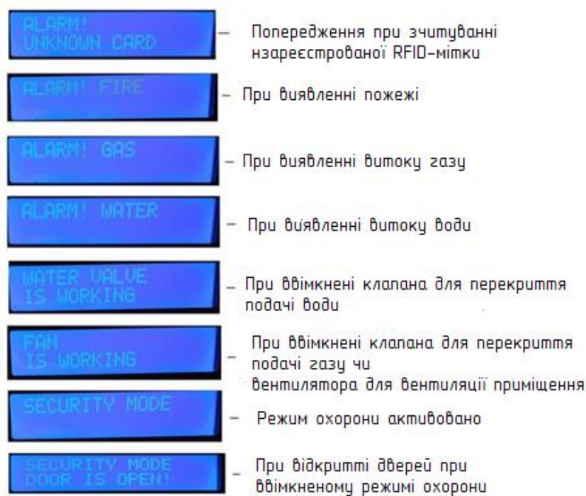
Рисунок 3.8 – Виведення інформаційних повідомлень на LCD-дисплей
