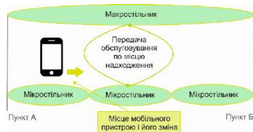
Рисунок 2.7 – Приклад передачі обслуговування (хендовера) з використанням інформації про місцезнаходження
