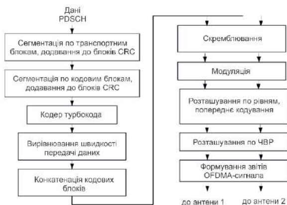
Рисунок 2.12 – Структурна схема кодування даних каналу PDSCH
