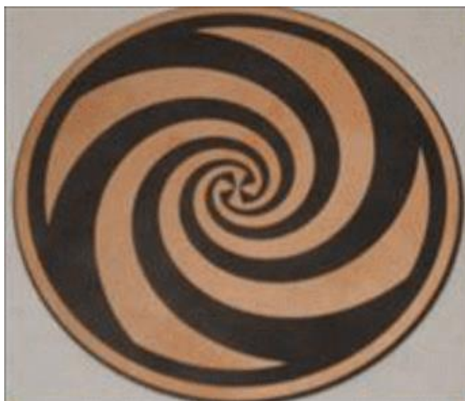
Рисунок 2.5 – Квадрифілярна логарифмічна спіральна антена
