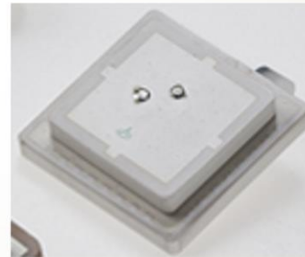
Рисунок 9. Патч антена з двоточковим живленням.
