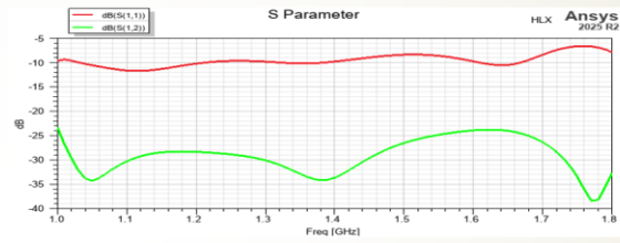
Рисунок 18 S-параметри антенної решітки
