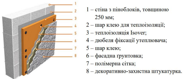
Рис 9. Конструкція зовнішніх самонесучих стін
