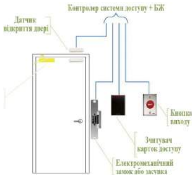
Рисунок 1.5 – Схема роботи простої СКД
