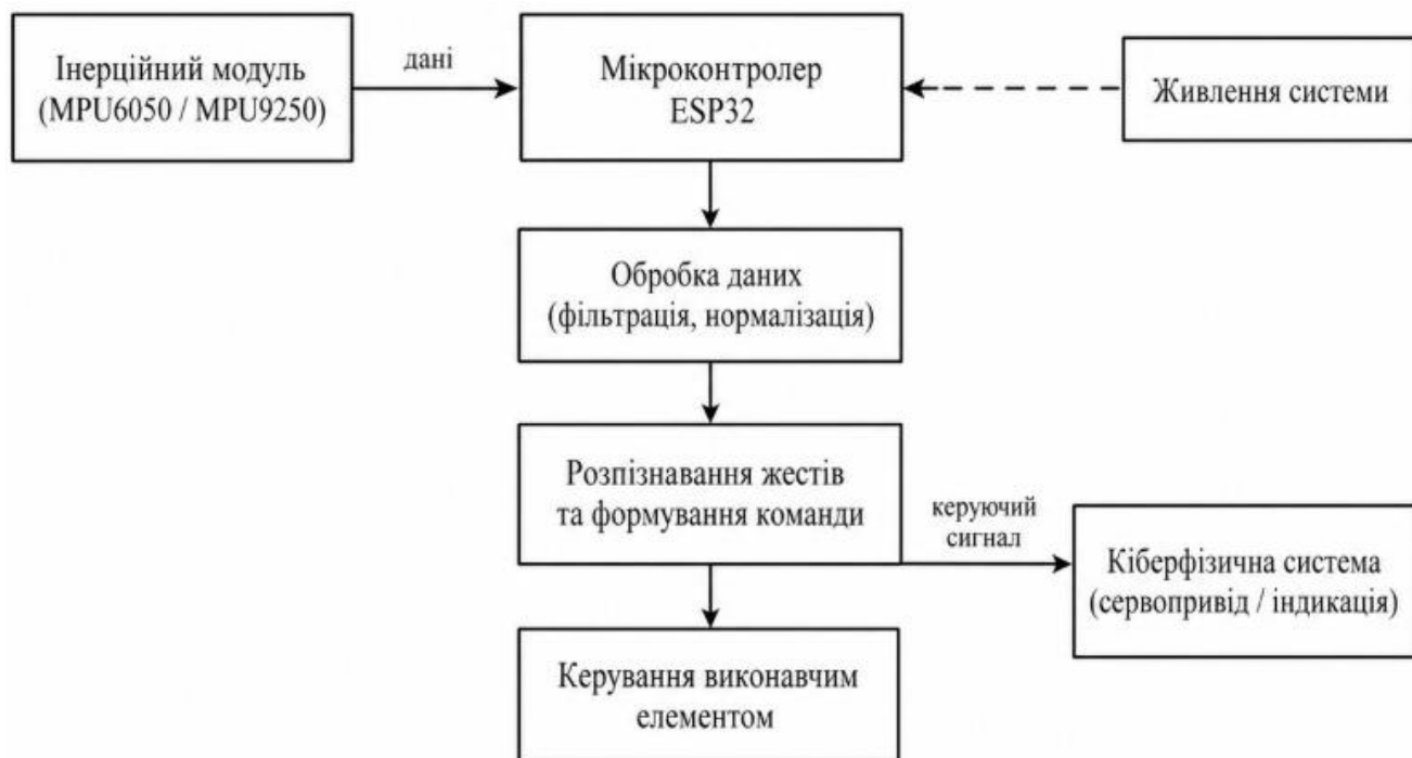
Рисунок 2.2 – Функціональний розподіл апаратних компонентів засобу жестового керування
