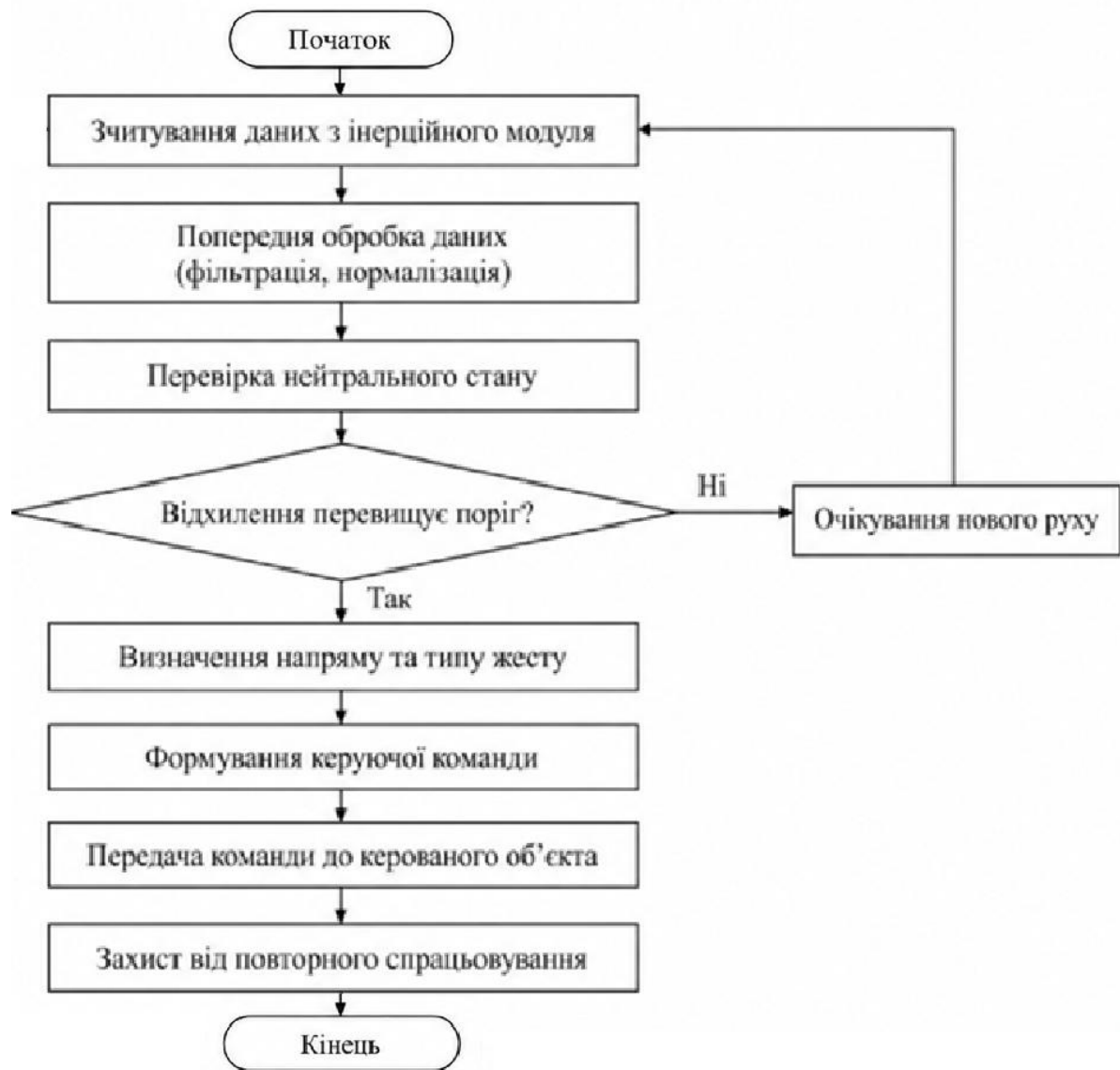
Рисунок 2.5 – Блок-схема перетворення рухів користувача у керуючі команди
