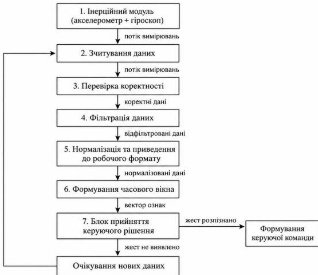
Рисунок 2.4 – Схема організації потоку даних від інерційного модуля до блока прийняття керуючого рішення
