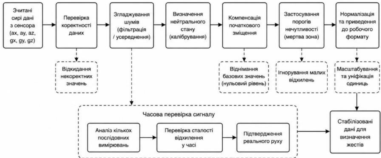
Рисунок 3.3 – Послідовність попередньої обробки та стабілізації вимірювань інерційного сенсора
