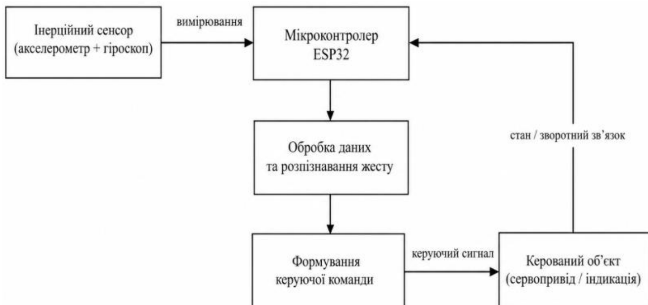
Рисунок 2.3 – Модель взаємодії інерційного сенсора, мікроконтролера та керованого об'єкта
