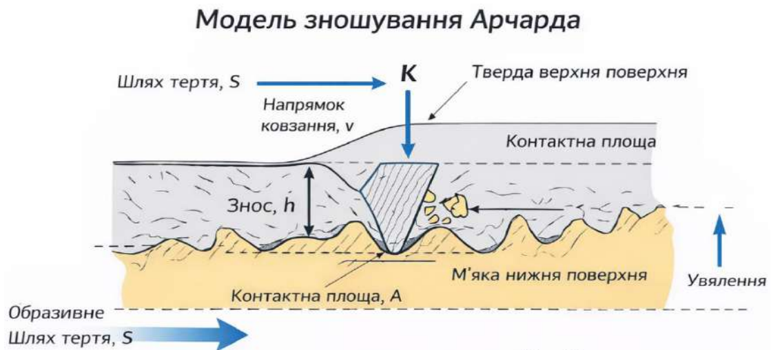
Рис. 2 – Схема моделі зношування Арчарда
