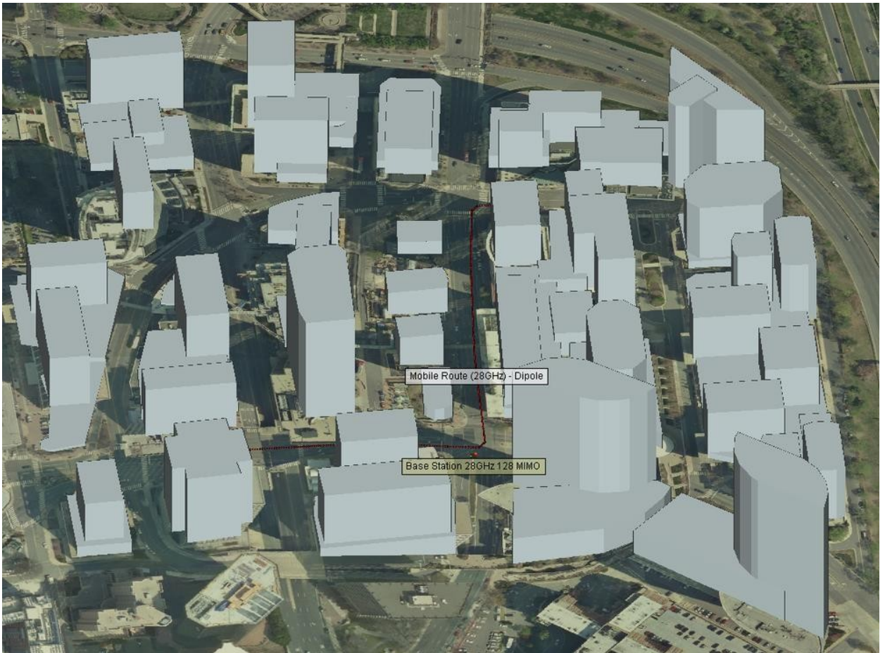
Рисунок 4.2 – Завантажена в Wireless InSite модель місцевості, з налагодженою базовою станцією і із заданим маршрутом руху мобільної станції
