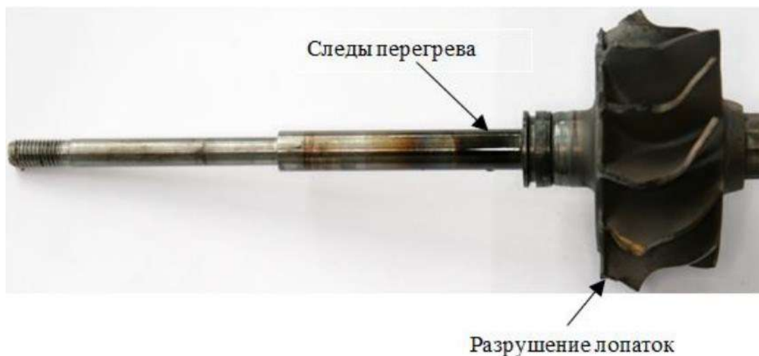
Рисунок 1.8. Пошкодження валу ротора внаслідок перевищення допустимої частоти обертання
