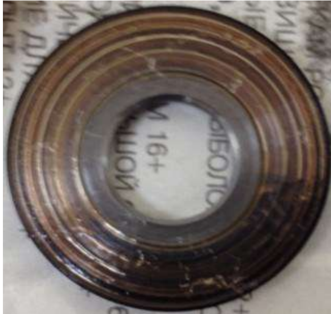
Рисунок 1.3. Знос несучої поверхні упорного ПК (а) - підп'ятник; б) п'ята)
