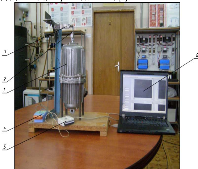
Рис. 2. Експериментальний стенд для дослідження приводів пресового обладнання на базі гідроштовхачів: 1 – гідроштовхач, 2 – датчик переміщення; 3 – тензодатчик; 4 – блок гальванічної розв'язки та підсилювач; 5 – аналого-цифровий перетворювач б-ЕОМ (гідроштовхачів) представлено на рис. 2.
