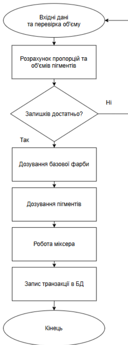
Рисунок 3.2 – Блок-схема алгоритму обчислення об'ємів та керування станами виконавчих механізмів
