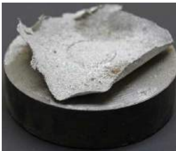
Рисунок 3.1 – Зовнішній вигляд зразка №1 після нанесення покриття.
