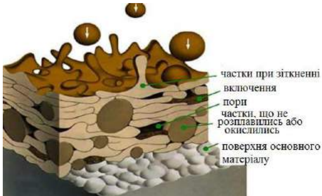
Рисунок 1.10 – Структура покриття отриманого газополуменевим напиленням
