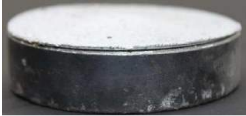
Рисунок 3.2 – Зовнішній вигляд зразка №2 після нанесення покриття.
