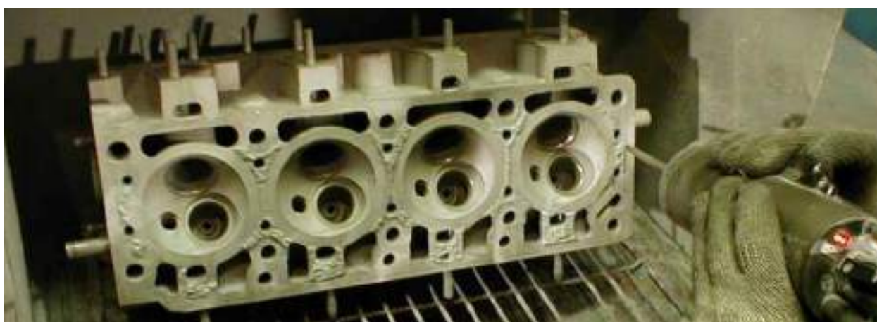
Рисунок 12 – Відновлення Г.Б.Ц. високошвидкісним напиленням
