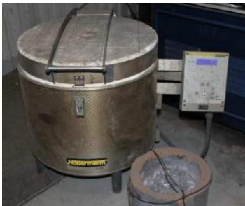
Рисунок 2.8 – Пекти Nabertherm Top 45 ECO, тигель для плавки алюмінію.
