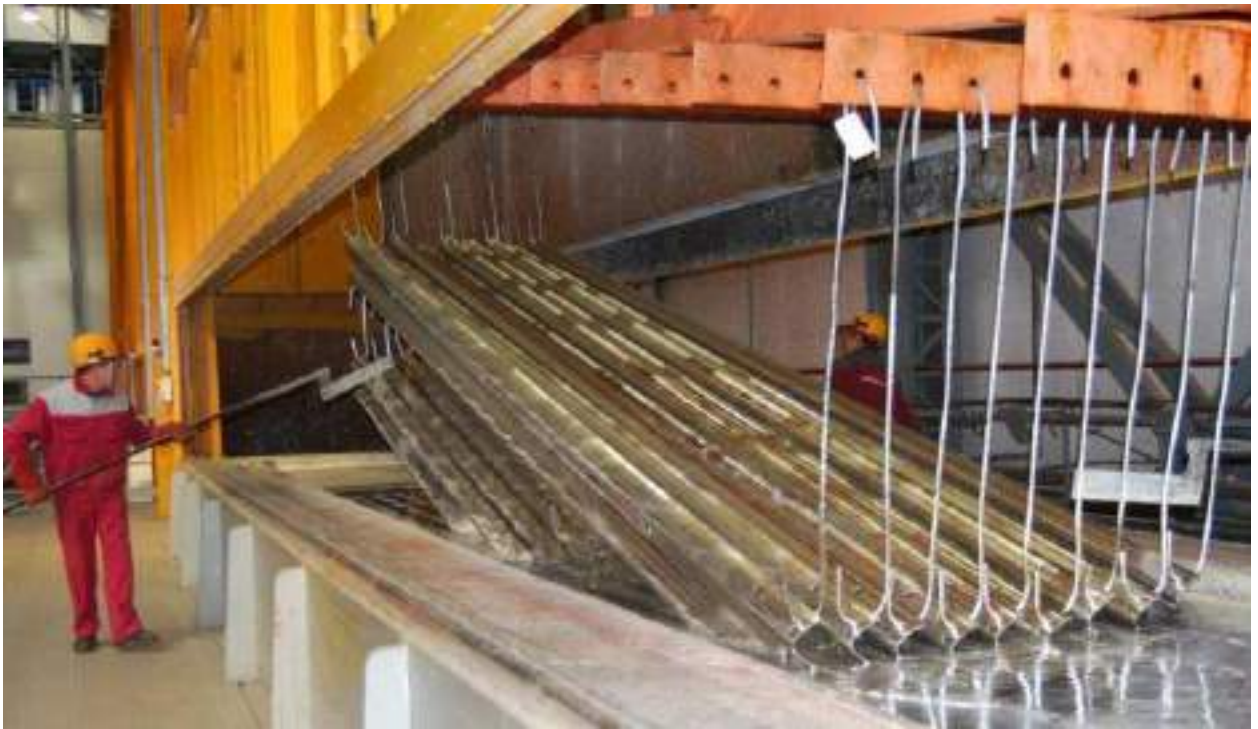
Рисунок 1.4 – Рідкофазне алітування балок сталевих конструкцій
