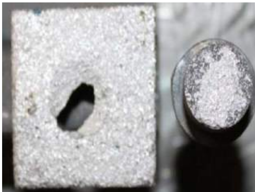
Рисунок 3.4 – Зовнішній вигляд зразка №4 після випробування на міцності зчеплення при температурах підігріву перед напилюванням 300 °С.
