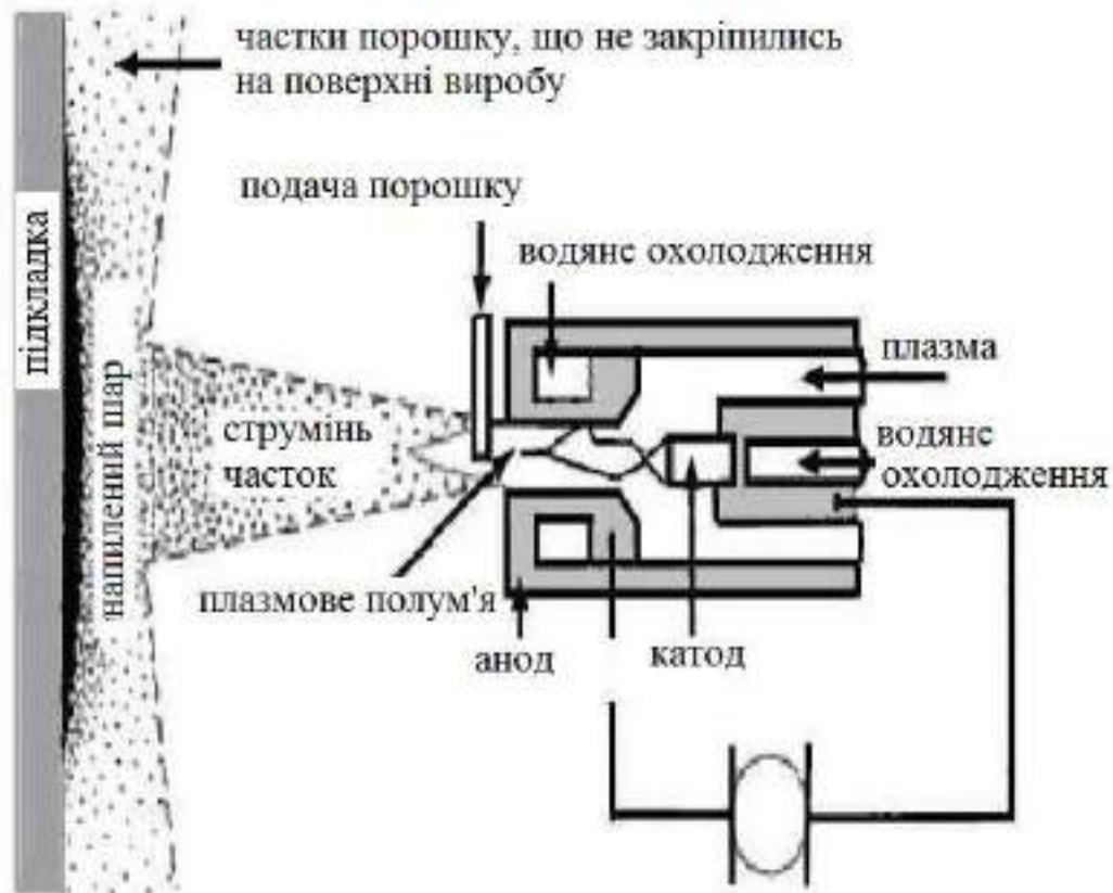
Рисунок 1.7 – Схема плазмового напилення матеріалів
