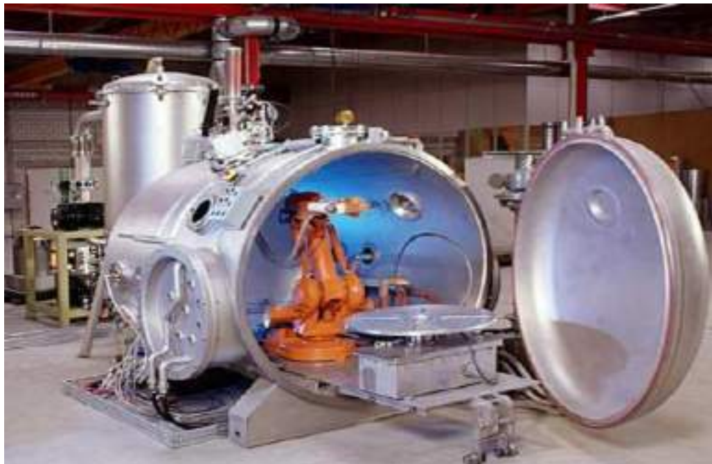
Рисунок 1.8 – Встановлення плазмового наплення у вакуумній камері
