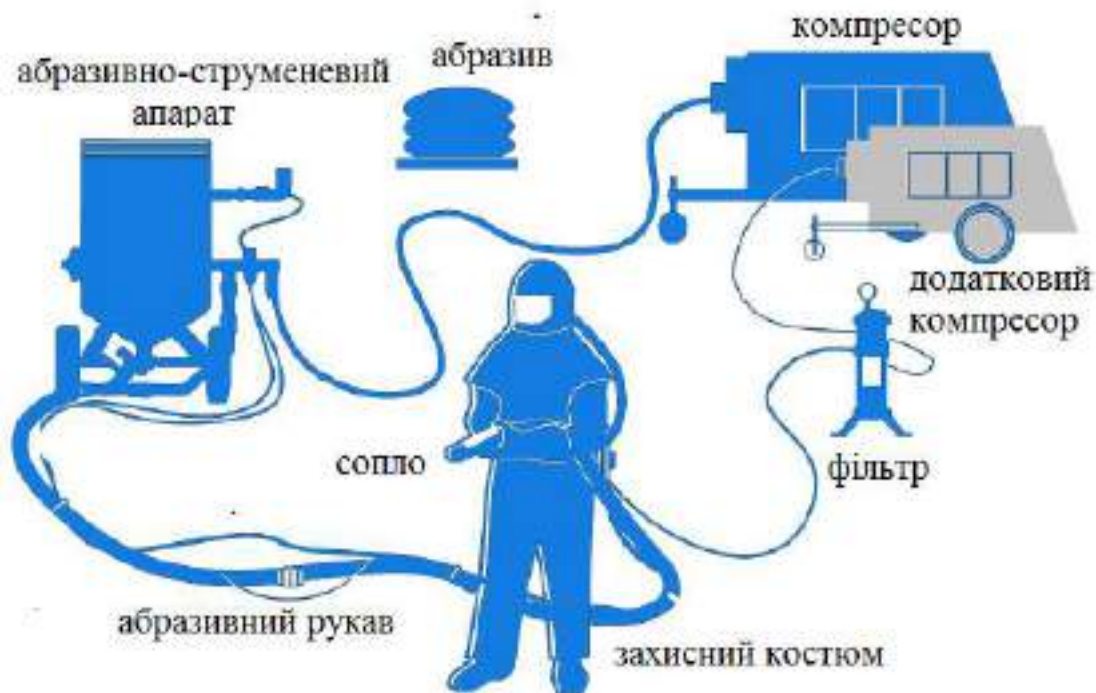
Рисунок 1.13 – Принципова схема абразивно-струминної обробки.
