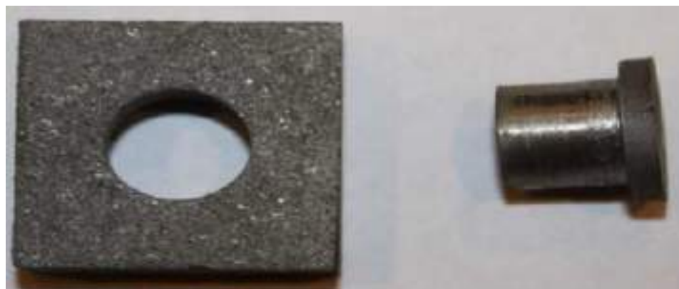
Рисунок 2.3 – Зовнішній вигляд зразка для дослідження міцності зчеплення покриття та основного металу
