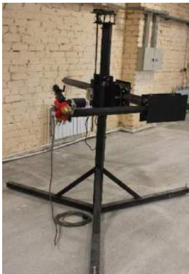
Рисунок 2.2 – Загальний вид установки для газополуменевого напилення з металізатором Плакарт FS-15.
