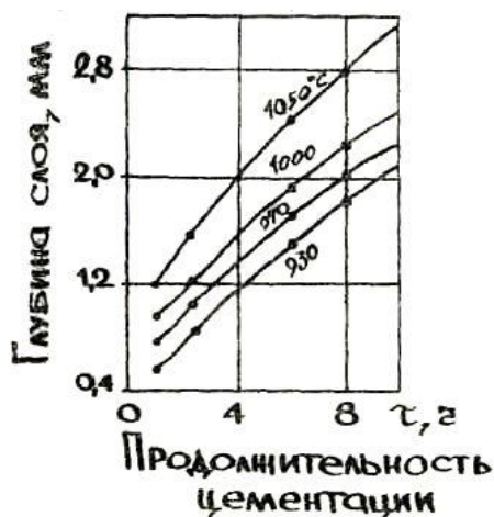
Рисунок 6.6 – Вплив на глибину шару тривалості цементації
