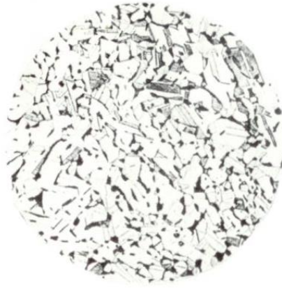
Рисунок 3.11 – Мікроструктура бронзи БрА10Ж4Н4Л після деформації та відпалу x250
