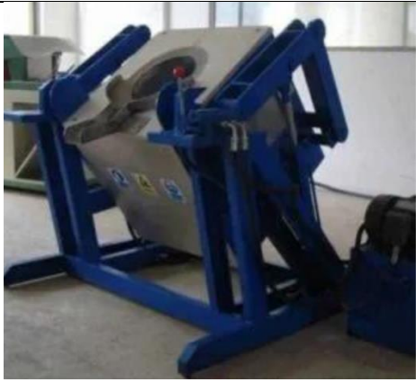
Індукційна піч для плавлення бронзи
