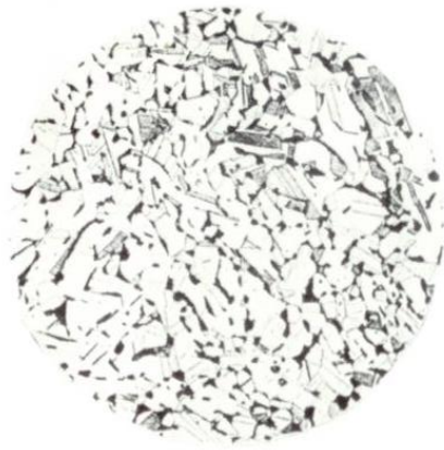
Мікроструктура бронзи BrA10Ж4Н4Л після деформації та відпалу x 250
