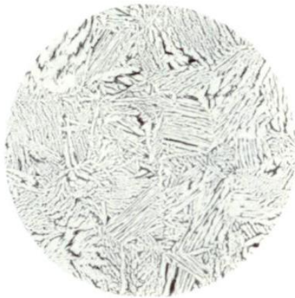
Мікроструктура алюмінієвої бронзи в литому стані \times 75 .
