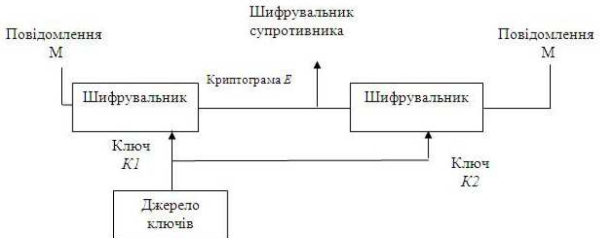
Рисунок 1.6 – Загальна структурна схема передачі інформації із застосуванням криптографії [30, 33, 45]
