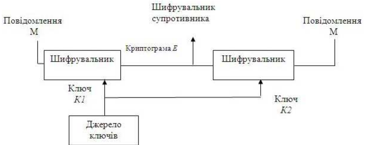
Рис. 3. Загальна структурна схема передачі інформації із застосуванням криптографії
