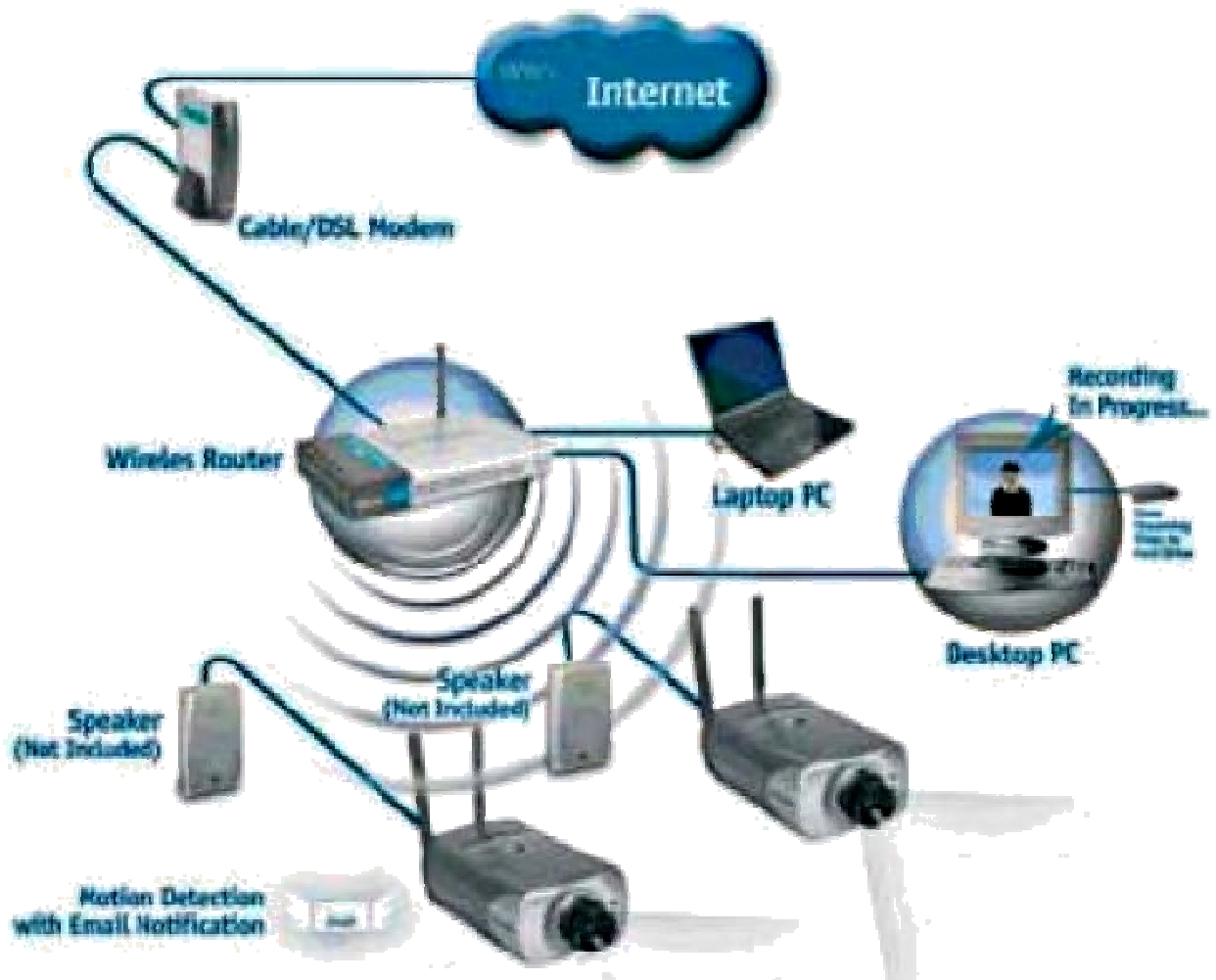
Рисунок 1.5 –Схема побудова відеосистеми на Wi-Fi [20, 45]
