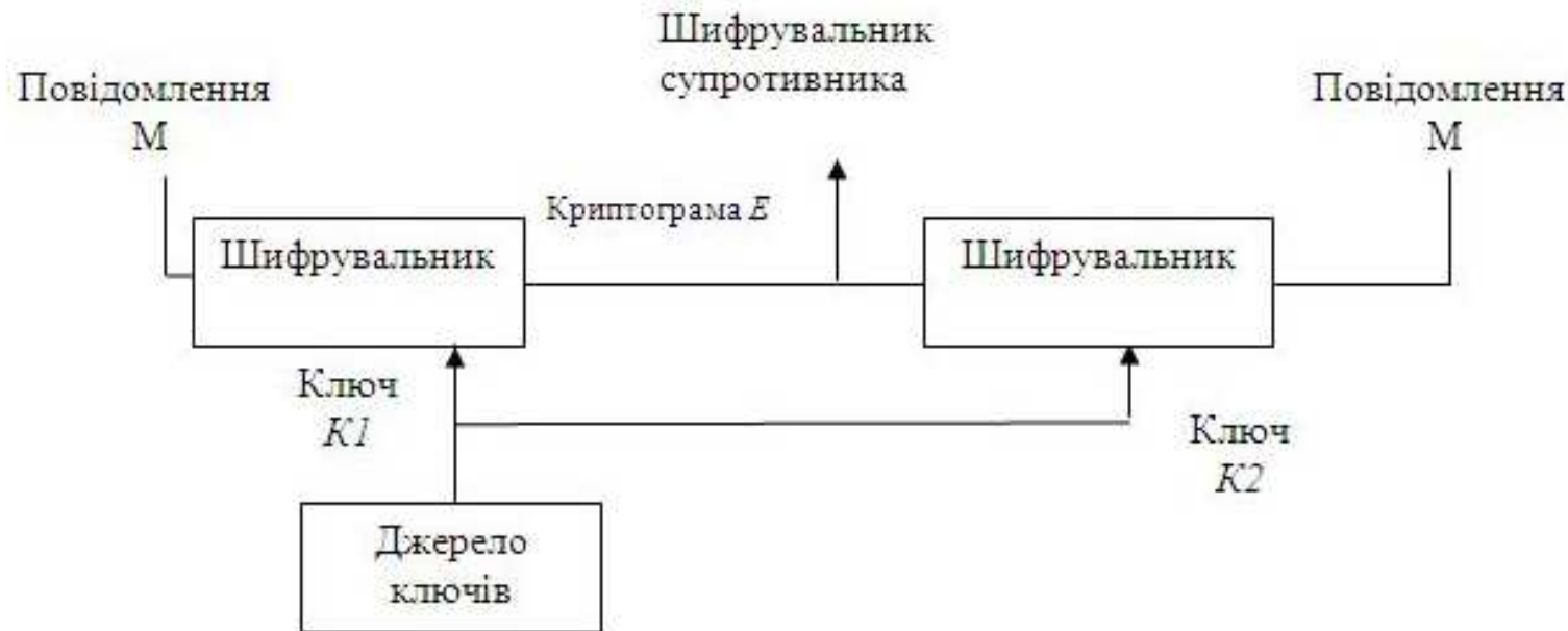
Рисунок 4.1 – Загальна структурна схема передачі інформації із застосуванням криптографії
