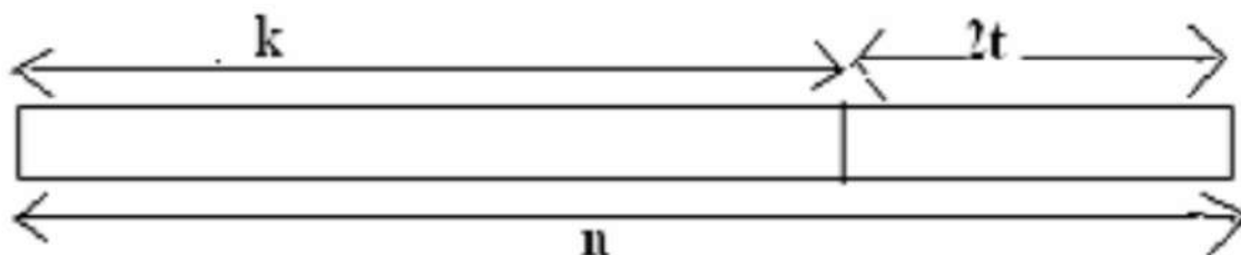
Рисунок 2.1 - Кодове слово кода Ріда соломона RS(n, k)
