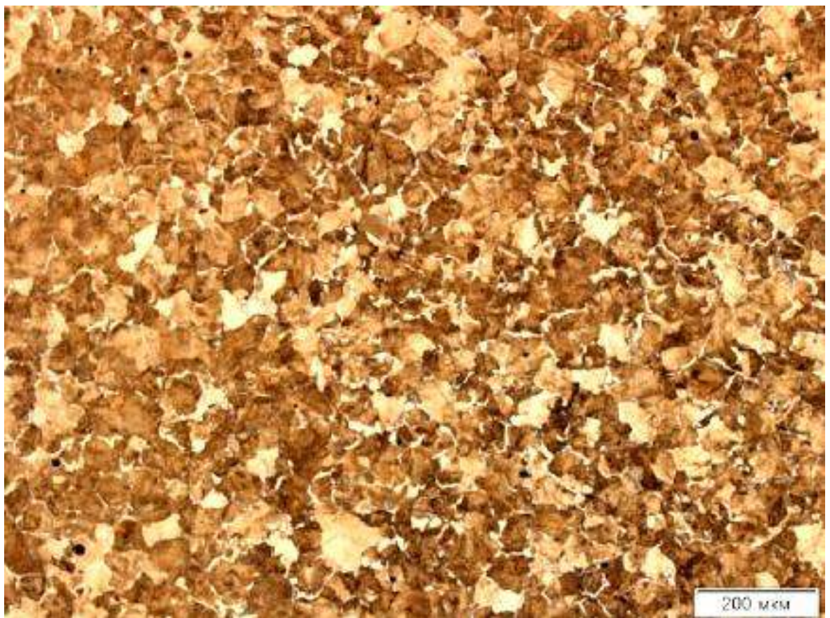
Рисунок 3.1 – Мікроструктура сталі 45ХС у нормалізованому стані ( t = 830\text{ °C} , витримка T_e = 80\text{ хв.} , HV 230)
