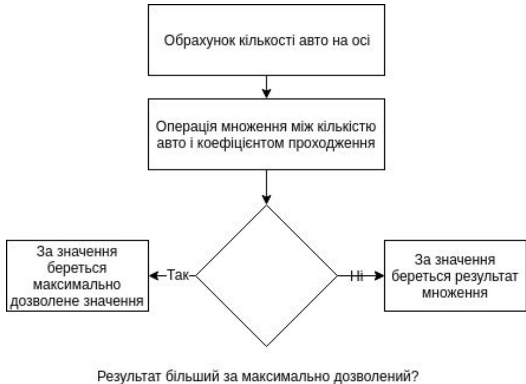
Рисунок 2.6. – Алгоритм обчислення часу на проходження
