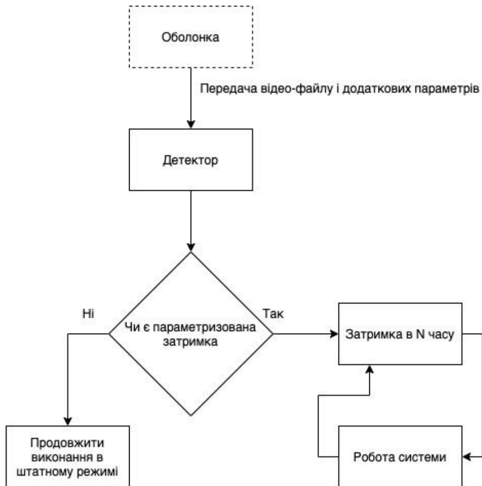
Рисунок 2.7. – Алгоритм дії детектора, якщо є параметризована затримка
