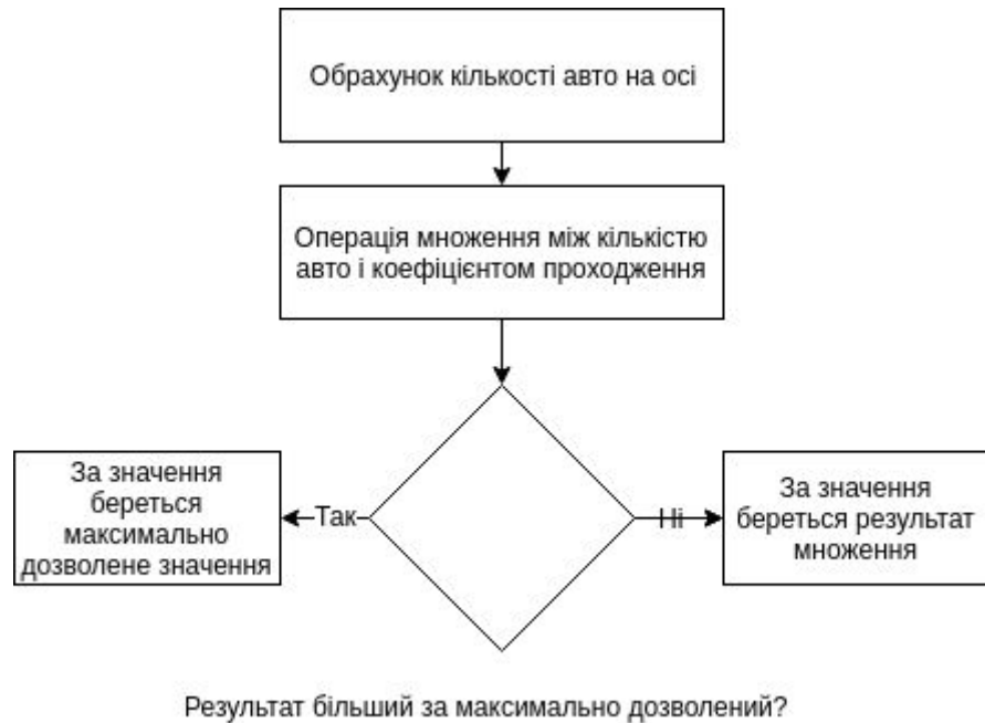
Рисунок 2.5 – Алгоритм обрахунку часу на проходження
