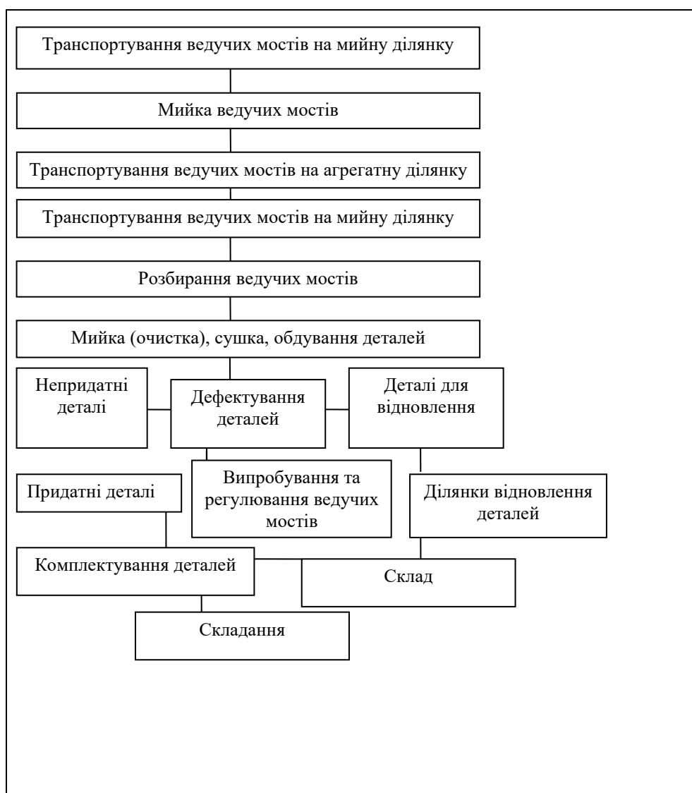
Рисунок 3.5 – Загальна схема ТП поточного ремонту ведучих мостів
