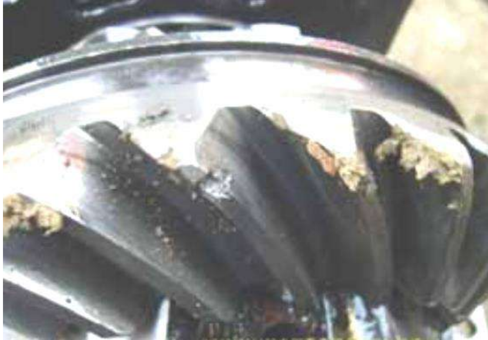
Рисунок 4.3 – Пломка зубів конічного зубчастого колеса ведучого мосту
