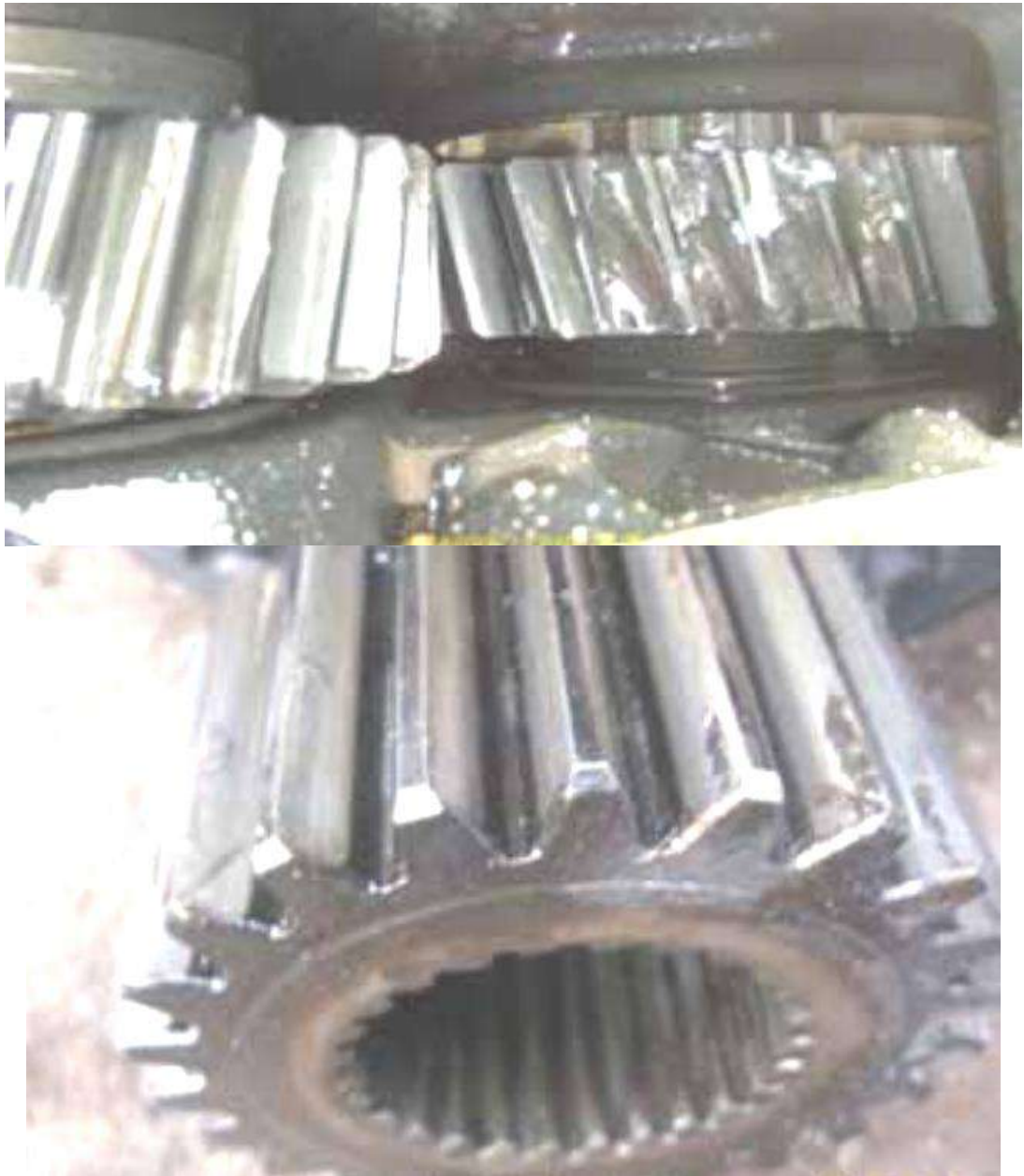
Рисунок 4.2 – Знос зубів зубчастих коліс ведучого мосту
