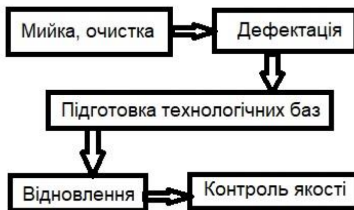
Рис. 8 – Загальна структура технологічного маршруту відновлення деталей
