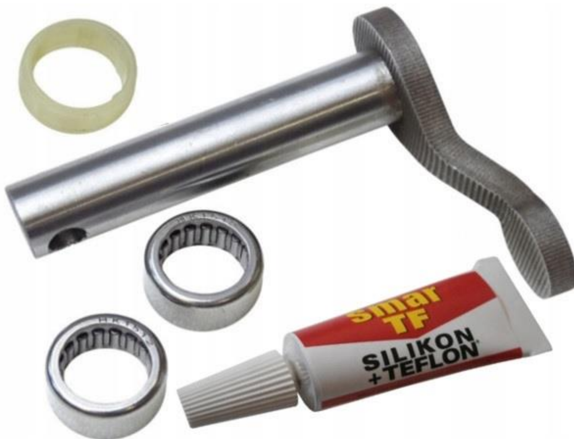
Рис. 2 – Куліса коробки передач рк5 6 рf6 автомобіля Renault Master Trafic
