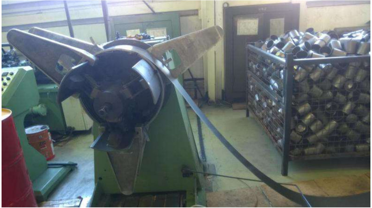
Рисунок 3.3 – Сталева стрічка подається на прес
