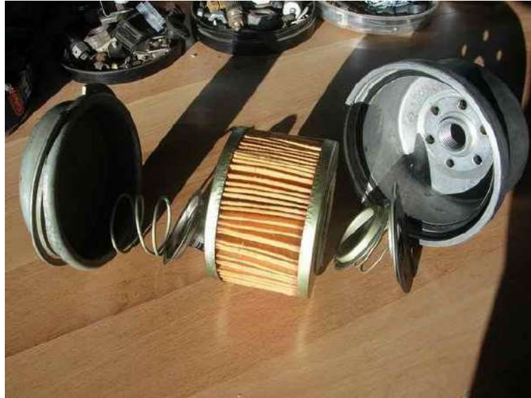
Рисунок 1.12 – «Кооперативний» розбірний масляний фільтр
