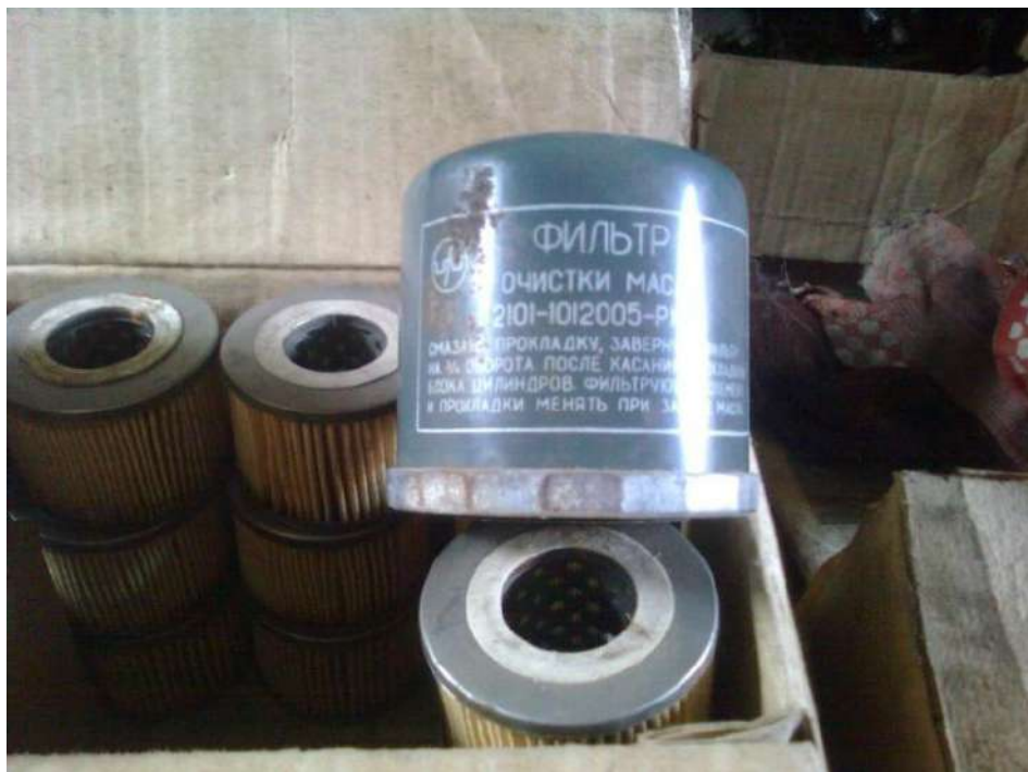
Рисунок 1.11 – Фільтр очищення олії, з комплектом змінних фільтруючих елементів, що застосовується для автомобіля ВАЗ 2101
