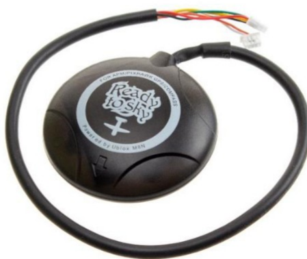
Рисунок 2.5 – GPS приймач u-blox M8N [28]
