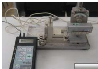
Рисунок 2.5 – Профілограф – профілометр АБРІС-ПМ7
