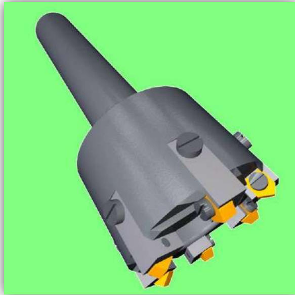
Рисунок 4.1 – Фреза торцева зі знімними ножами зі швидкорізальної сталі Р6М5
