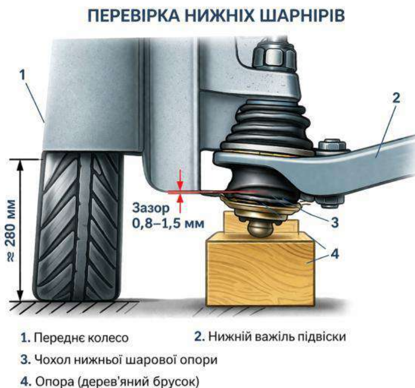
Рисунок 1.5 – Схема перевірки нижніх шарових шарнірів:
