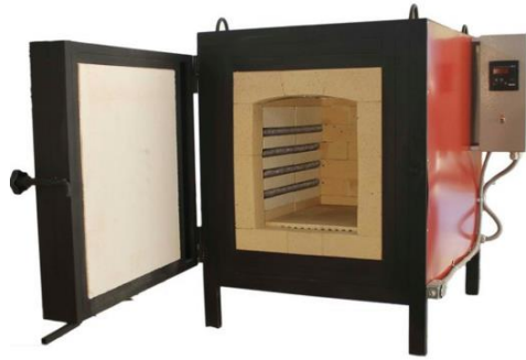
Рисунок 1.6 – Камерна піч для гартування
