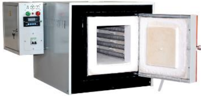
Рисунок 1.9 – Лабораторна муфельна піч
