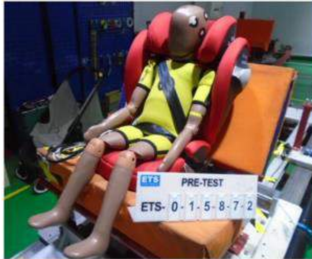
Рисунок 1.9 – Установка для випробування фронтальних саней.
