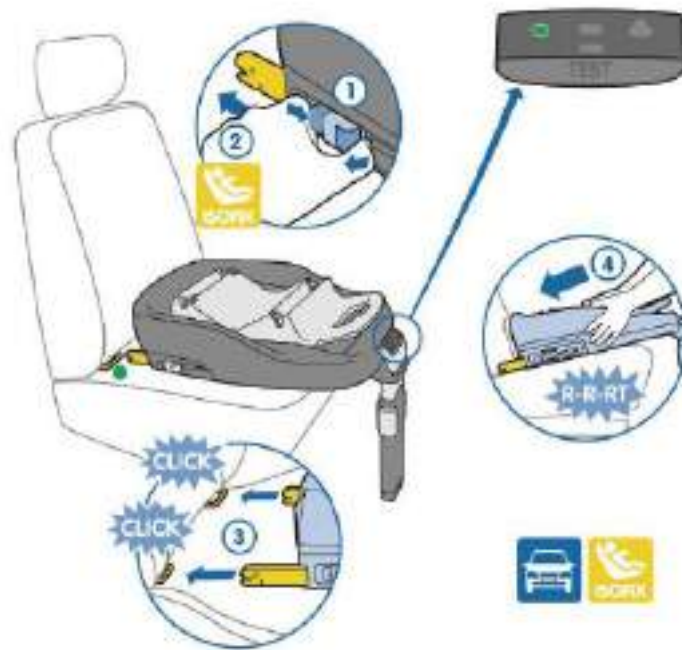
Рисунок 1.6 – Схема встановлення системи ISOFIX.
