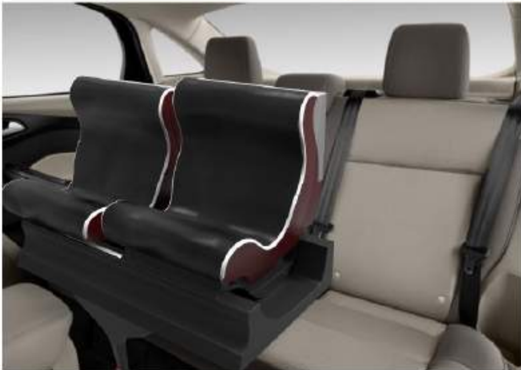
Розміщення конструкції каркасу в салоні автомобіля
