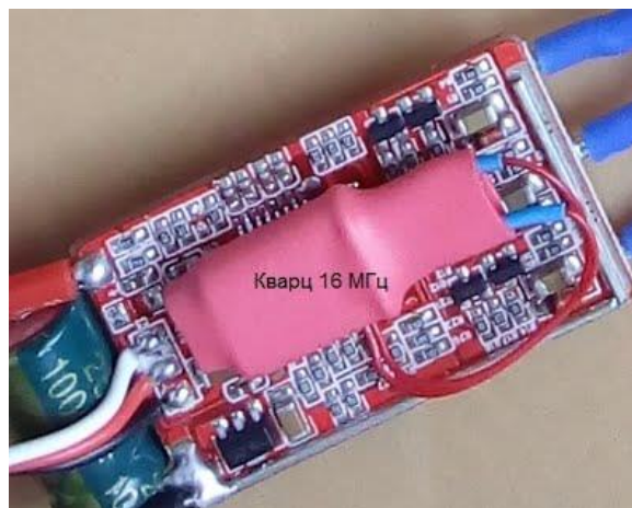
Рис.5. Установка кварцевого резонатора 16 МГц
