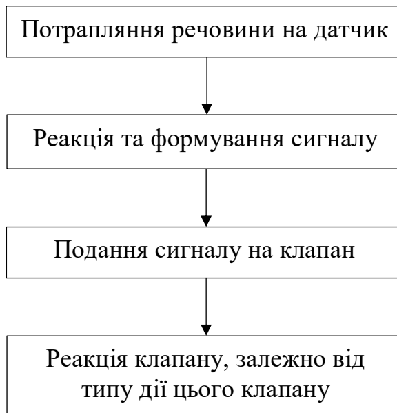
Рисунок 1.1 – Узагальнена схема роботи клапанів
