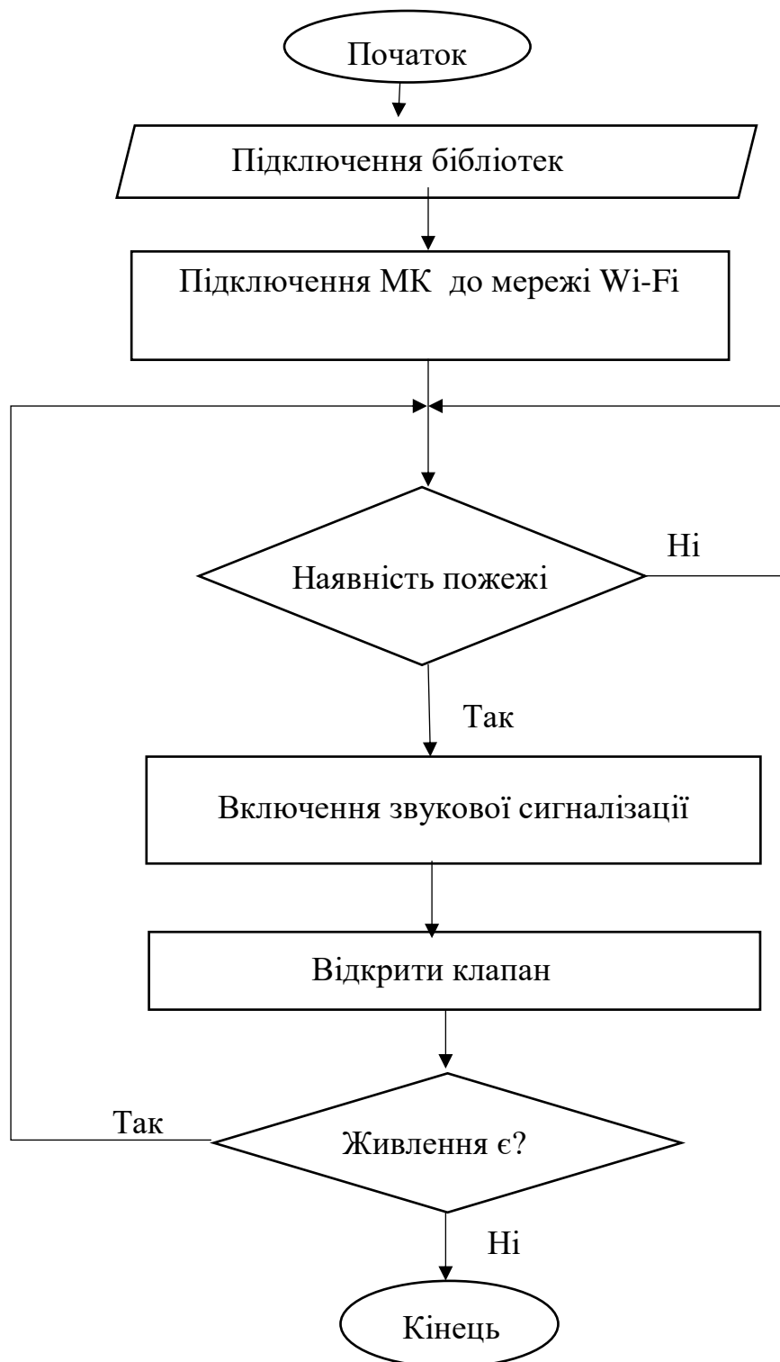
Рисунок 3.1 – Блок-схема загального алгоритму роботи мікроконтролерної системи керування клапаном
