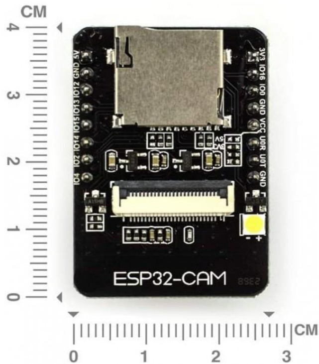
Рисунок 2.10 – Розміри МК ESP32-CAM [62]
