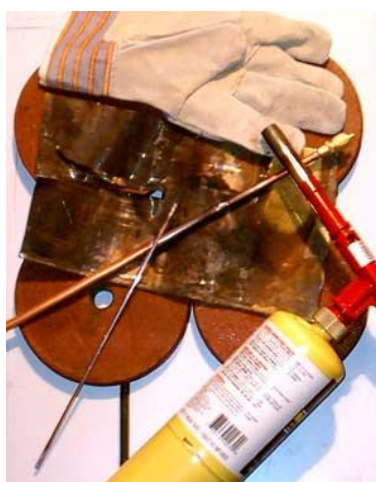
Рисунок 2.4 - Робочий інструмент для пайки теплової трубки
