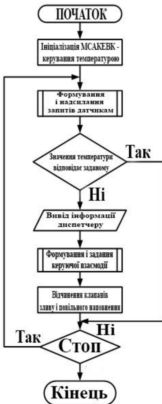
Рисунок 3.3 – Блок-схема алгоритму МСАКЕВК – керування (регулювання) температурою
